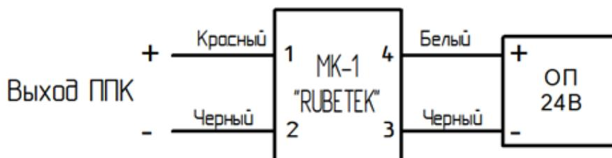
Рисунок 16 - Схема подключения МК-1 к ОП
