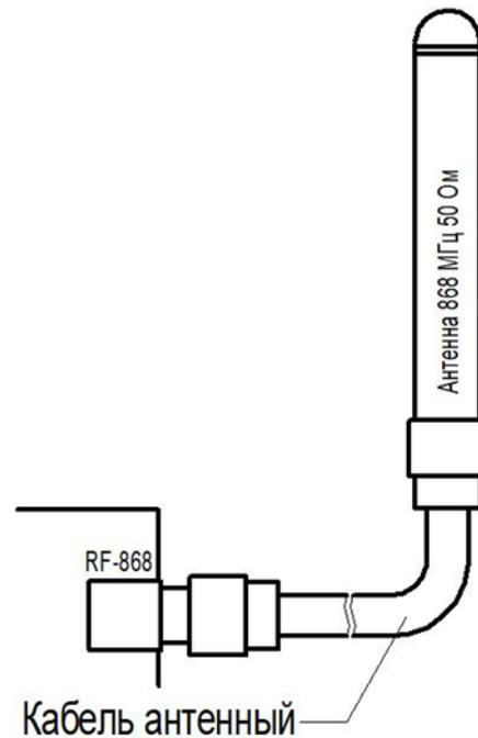
Рисунок 6 - Подключение антенны
