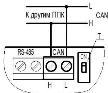
T – переключатель оконечного резистора (терминатора) интерфейса CAN
