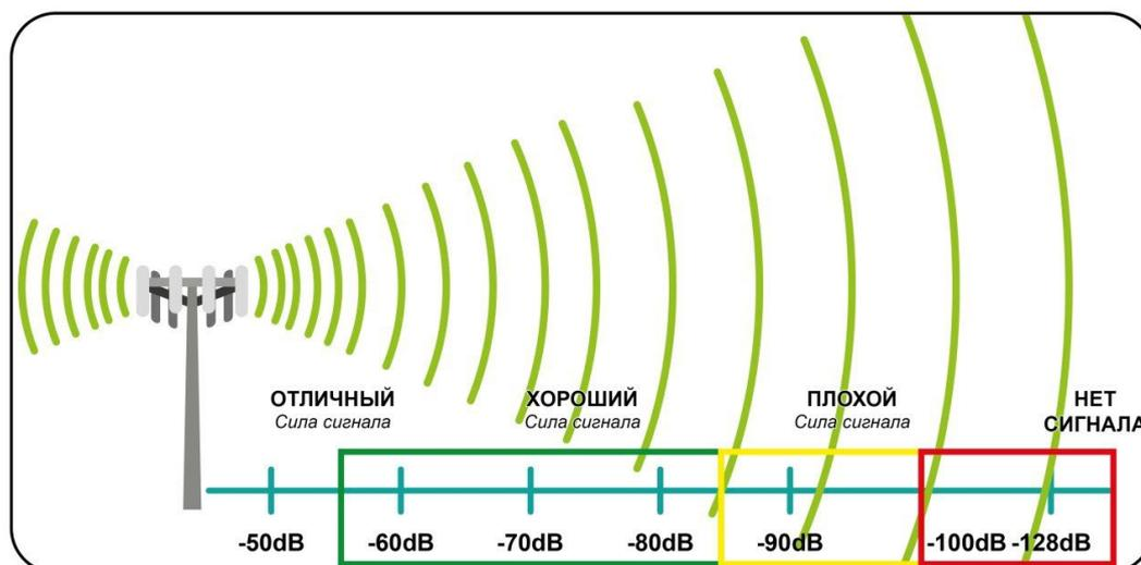
Рисунок 9 - График качества сигнала связи
