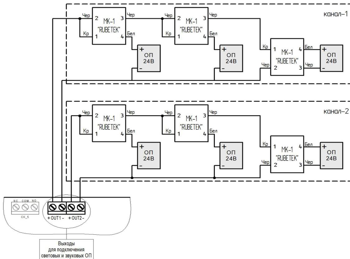
Рисунок 15 - Схема подключения световых и звуковых ОП
