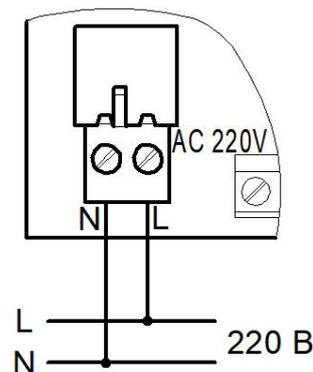
Рисунок 8 - Подключение питания клапанов
