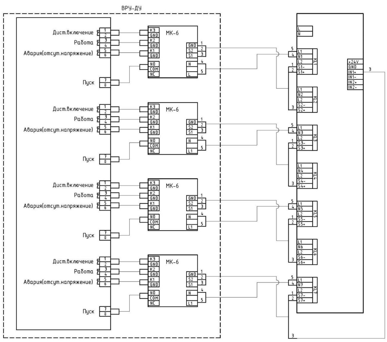
Рисунок 10 - Схема подключения шкафа управления вентиляцией
