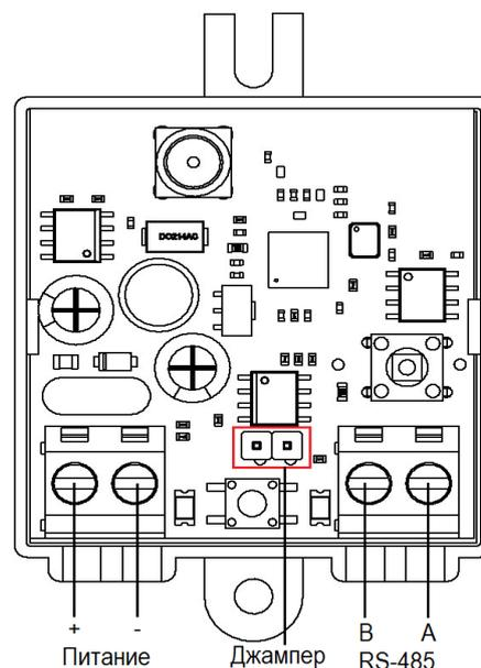
Если ППК является окончательным в сети RS-485, то установить переключатель окончательного резистора RS-485 в положение «ON».
