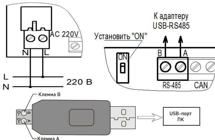
Рисунок 22 - Схема подключения адаптера USB-RS485
