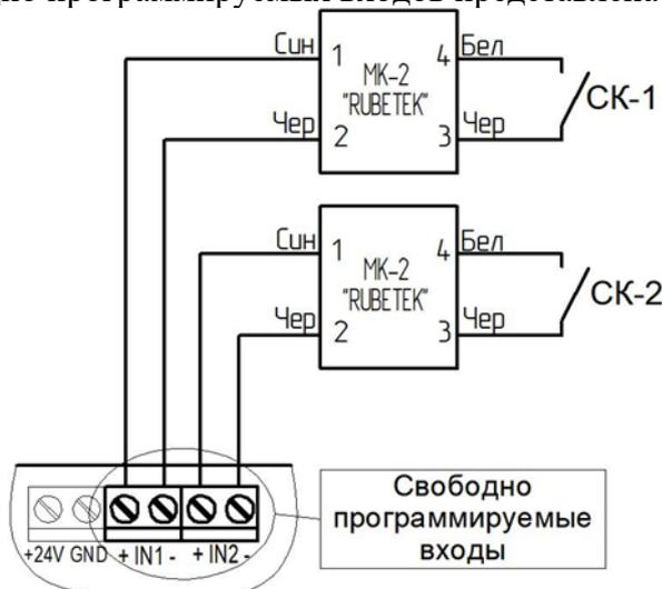
Рисунок 18 - Схема подключения свободно программируемых входов
