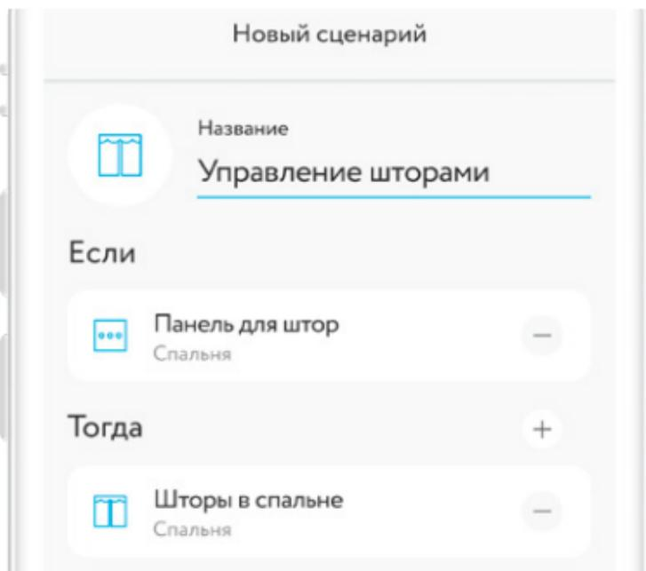
Теперь при нажатии на кнопки  $\Delta$  и  $\nabla$  Панели, шторы будут закрываться или открываться. Нажатие на среднюю кнопку  $\square$  приведет к остановке их движения.
