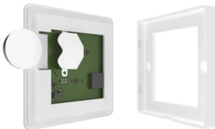
2. Зафиксируйте рамку на стене с помощью двух саморезов или же приклейте ее на ровную поверхность, используя двусторонний скотч, расположенный на рамке.
