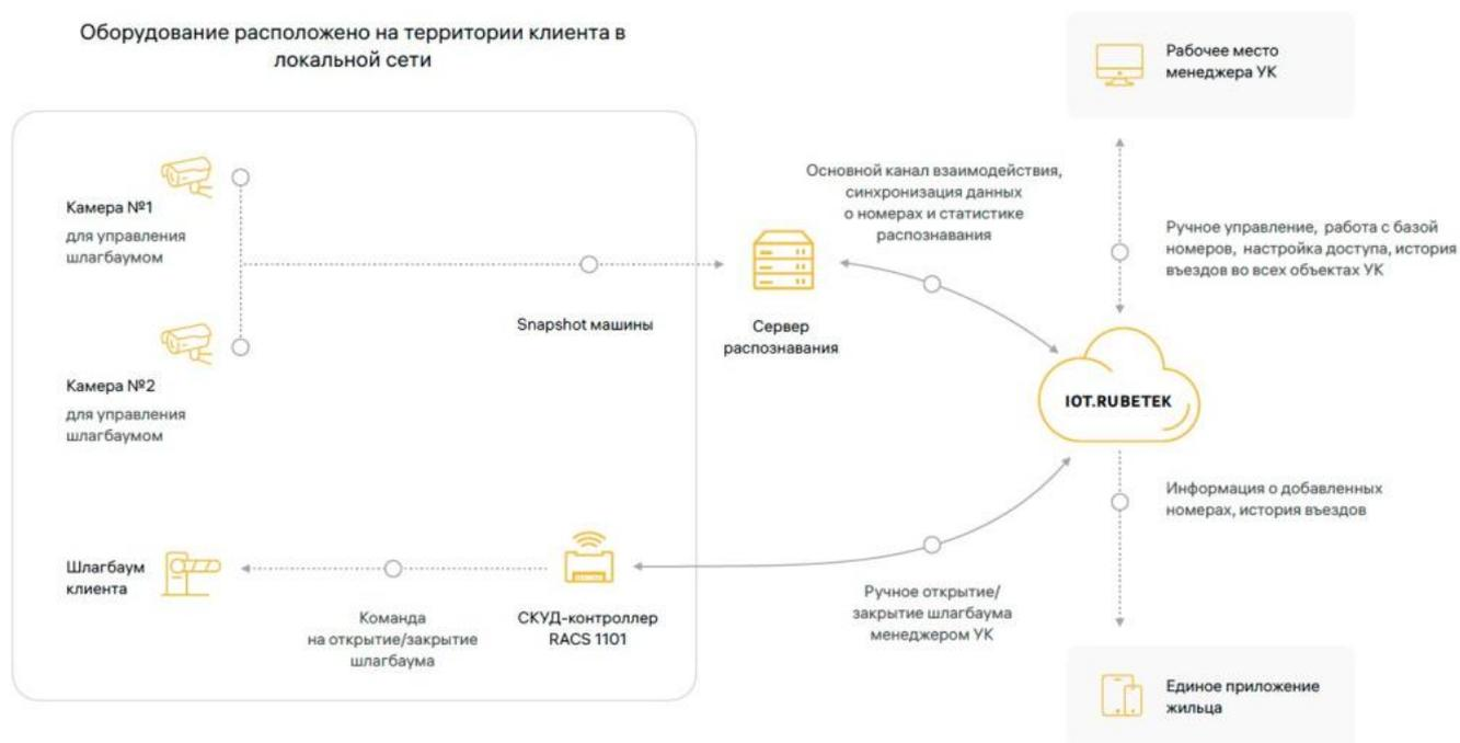
Рисунок 1 – Система распознавания автомобильных номеров Rubetek CarID
