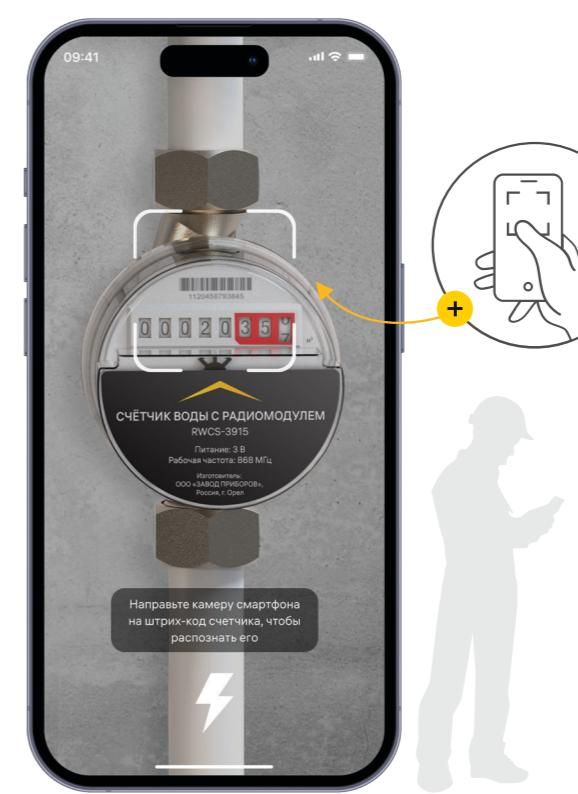
2 Инсталлятор обходит подъезд и добавляет приборы учёта с помощью приложения. При сканировании штрих-кода счётчика, его номер и показатели автоматически привязываются к квартире.
