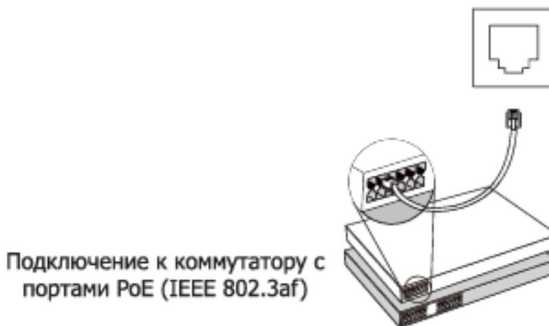
Рисунок 1 – Подключение SIP-трубки к сети и питанию
