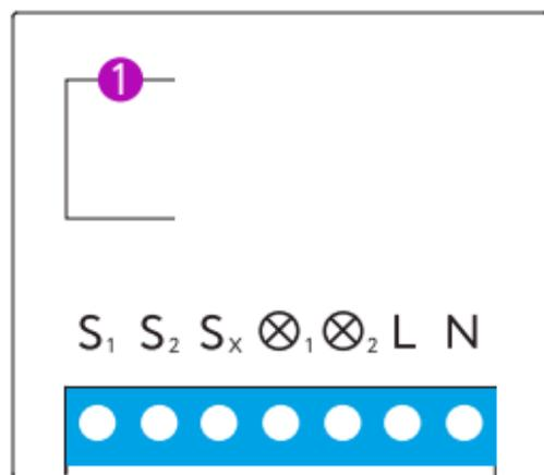
S<sub>1</sub>, S<sub>2</sub>, S<sub>x</sub> – разъёмы кнопок выключателя
