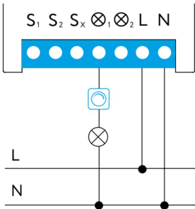
Освещение с двумя проходными
