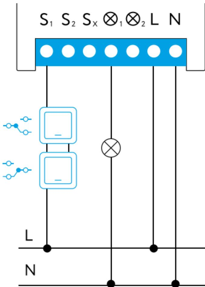
Освещение с двумя проходными
