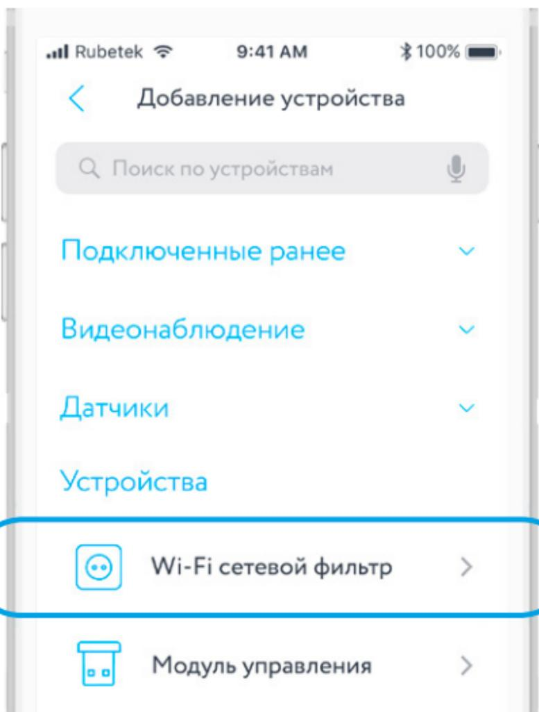
3. Переведите Wi-Fi сетевой фильтр в режим добавления. Для этого нажмите и удерживайте более 6 сек. кнопку питания на Wi-Fi сетевом фильтре, и следуйте подсказкам на экране:
