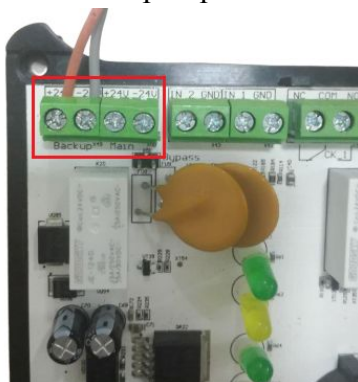
Рисунок 3 - Разъем основного и резервного питания ППК
