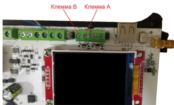
Рисунок 4 - Распиновка разъема RS-485 на ППК
