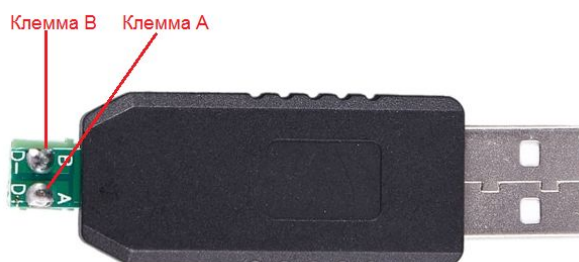
Рисунок 5 - Распиновка разъема RS-485 на адаптере
