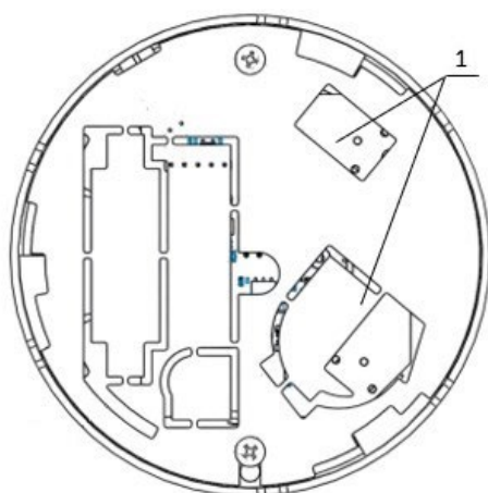
Рисунок 3 - Внутреннее устройство извещателя
