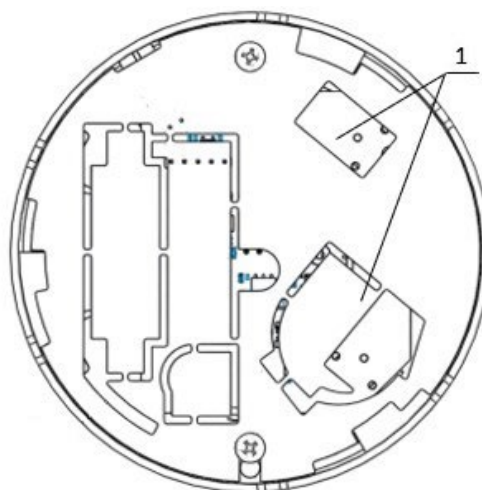
Рисунок 3 - Внутреннее устройство извещателя
