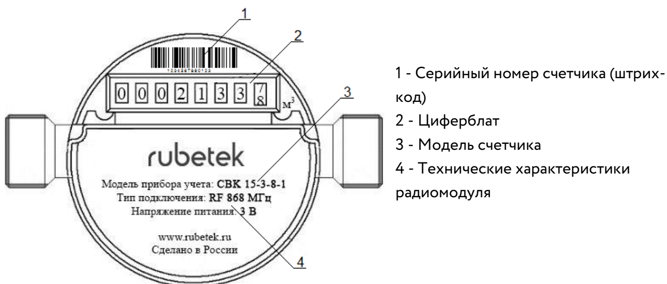
Рисунок 1 – Внешний вид счетчика с установленным радиомодулем (вид сверху)
