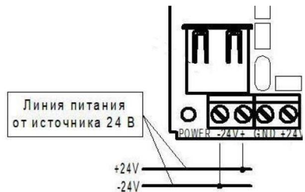
После подачи напряжения на линии питания. Убедитесь в переходе прибора в режим «Норма». Светодиод (1) должен постоянно светиться красным цветом.
