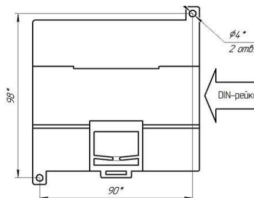
Закрепить корпус прибора на поверхности при помощи дюбелей и шурупов из комплекта поставки.
