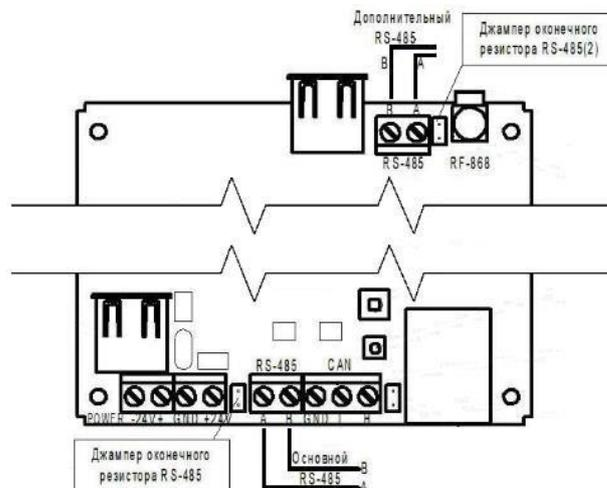
**!** **ВАЖНО!** Если прибор является оконечным в линии интерфейса RS-485, необходимо установить перемычку (джампер) из комплектации прибора на штыри рядом с контактами интерфейса RS-485.
