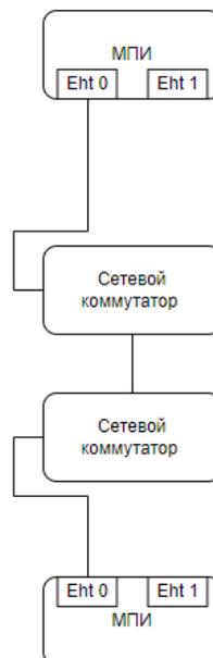
Рисунок 7 – Режим работы: один интерфейс
