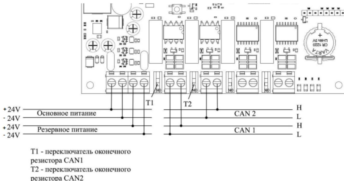
Рисунок 10 – Схема подключения интерфейса CAN и линии питания
