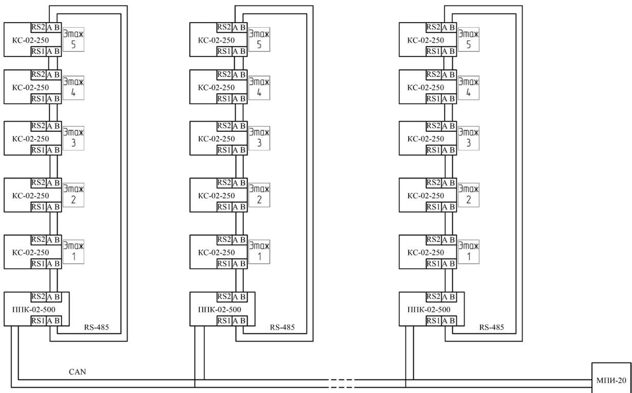
Рисунок 6 – Типовая схема подключения (для ППК-02-500)
