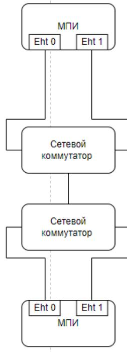
Рисунок 9 – Режим работы: два равнозначных интерфейса
