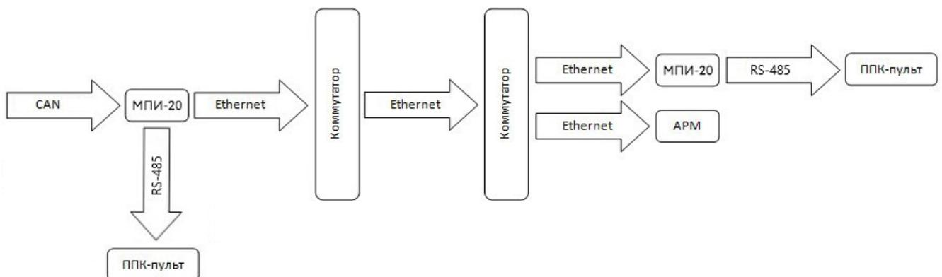
Рисунок 4 – Принципиальная схема организации Ethernet сети (для ППК-02-500)
