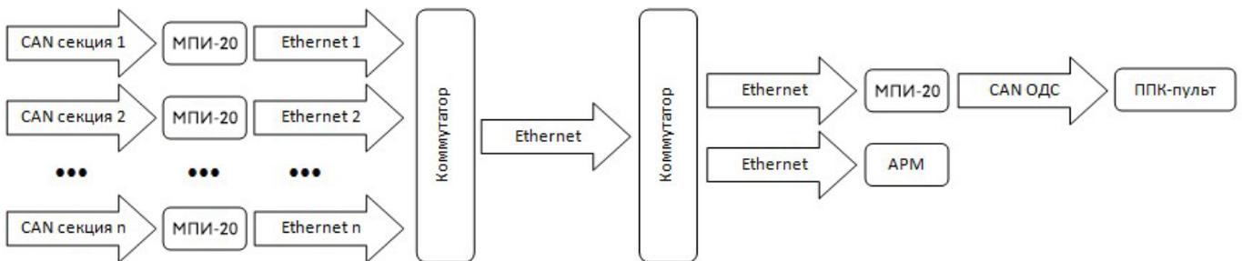
Рисунок 3 – Принципиальная схема организации Ethernet сети (для ППК-02-250)
