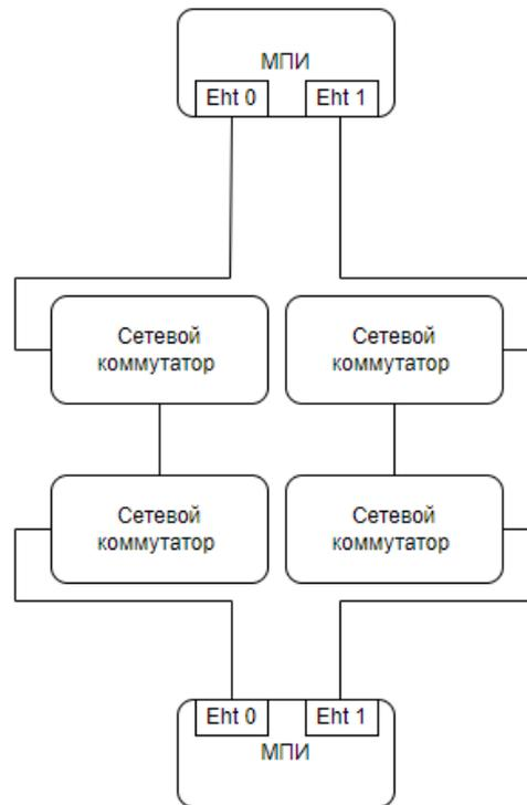
Рисунок 8 – Режим работы: два отдельных интерфейса
