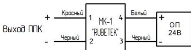
Рисунок 19 – Схема подключения МК-1 к ОП
