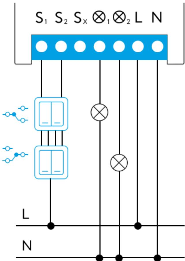
Освещение с двумя
