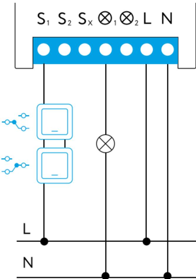
Освещение с двумя проходными
